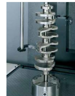
シリンダブロックやクランクシャフトの測定例
