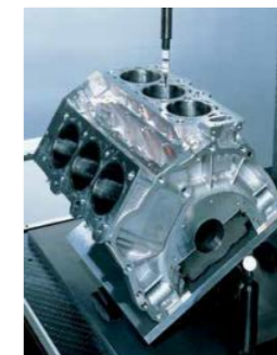
シリンダブロックやクランクシャフトの測定例
